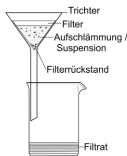
Abb.32: Versuchsaufbau für richtiges Filtrieren im Labor
