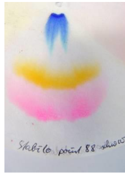
Abb.35: Chromatogramm eines Stabilo®-Fineliner „point 88“
