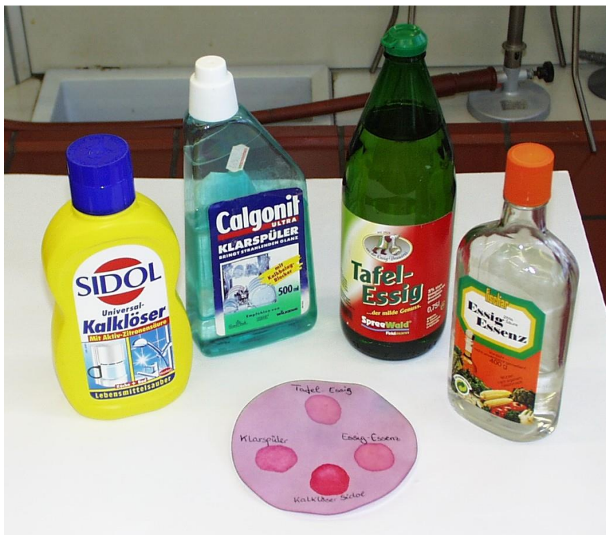
Abb. 1: Untersuchung verschiedener saurer Stoffe aus dem Haushalt mit Rostkohll-Indikatorpapier
