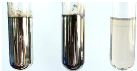
Abb. 64: oxidierte Alkohollösungen mit Tollens-Reagenz (v. l.: Ethanol, Propan-1-ol, Propan-2-ol)
