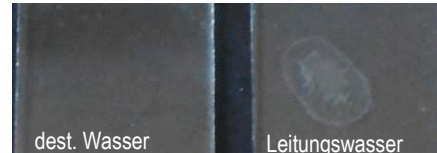
Abb. 76: eingedampfte Tropfen (dest. Wasser l., Leitungswasser r.) auf einem Objektträgerglas
