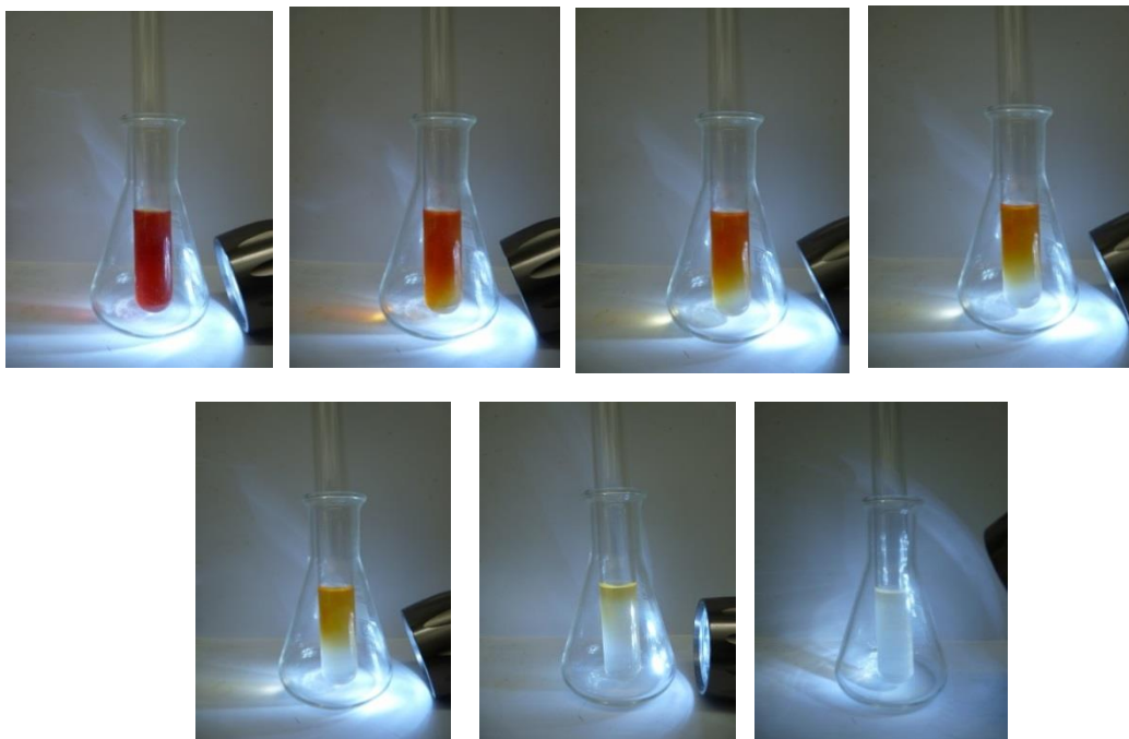
Abb. 54: Entfärbung mittels tragbarer Fahrradlampe mit zunehmender Zeit
