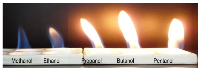
Abb. 18: Flammenfarben der Alkohole der homologen Reihe
