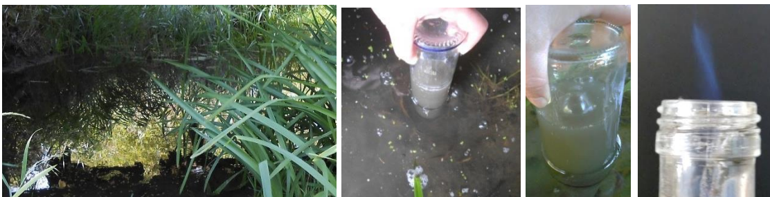
Abb. 44: stehendes Gewässer (l.); Sammeln von Methangas mit aufsteigenden Gasblasen (m.) und Verbrennung des gesammelten Gases im Labor (r.)
