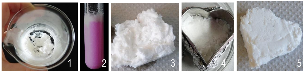
Abb. 74: entstehender Salzkern im Becherglas (Bild 1), Schaumbildung im Reagenzglas (Bild 2), abgeschöpfter Salzkern (Bild 3), Salzkern in Plätzchenform (Bild 4), Salzkern getrocknet (Bild 5)
