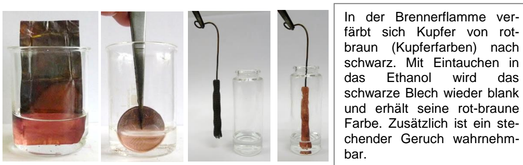
Abb. 61: Reaktion von Ethanol mit CuO
