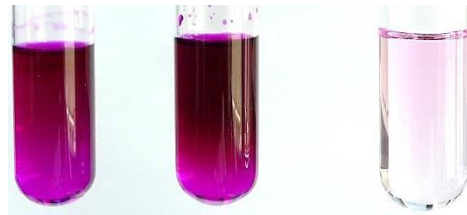
Abb. 65: oxidierte Alkohollösungen mit Schiffs-Reagenz (v. l.: Ethanol, Propan-1-ol, Propan-2-ol)
