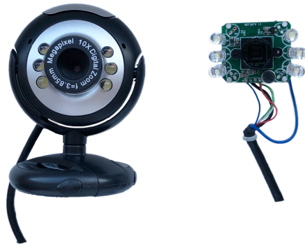
Abb. 4.8: Demontage einer einfachen Webcam für Versuch 3
