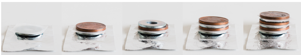
Abb. 4.21: Selbstbau einer Batterie aus Unterlegscheiben und Euro-Cent-Münzen
